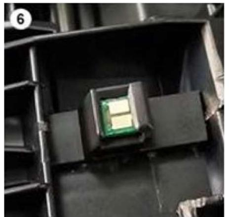
6 Setzen Sie den neuen **RevoSet** Reset-Chip ein
