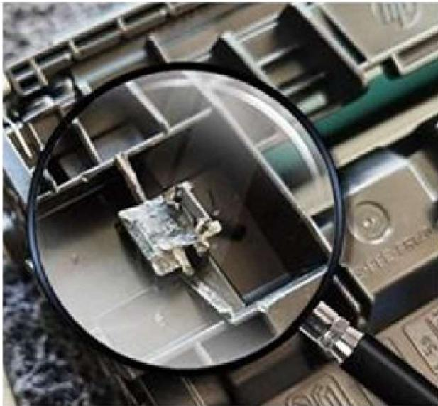
Die **RevoSet** Halterung für Reset-Chips an HP Tonerkassetten 59A/X ersetzt die originale Chip Halterung, wenn diese beim Ausbau des Chips beschädigt wurde.
